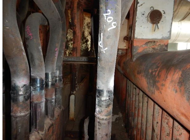
Tertiary SH butt welds and PT UT NDE
